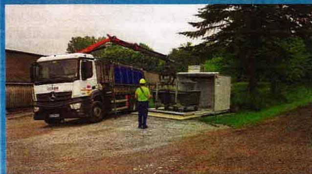
Le bac est repris par la grue du camion d'équarrissage, commandée par un joystick puis est reposé sur le plateau. ©A. Puybasset
