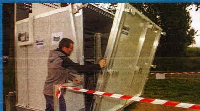
Déverrouillée via une boîte à code, la porte à pont-levis est ouverte mécaniquement et abaissée au sol. ©A. Puybasset
